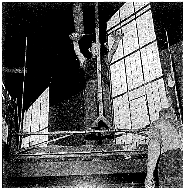
Korsør Glasværk fremstiller vinduesglas efter den såkaldte „Fourcault“ metode med p. t. ialt 4 maskiner. Hver maskine trækker glasset fra ovnen op igennem en dyse til et 190 cm bredt bånd, der af asbestvalse føres til en højde af ca. 8 m over ovnen, hvor glasset afskæres – „brydes“ – i store stykker, hvorefter det transporteres til skæresal og lager. Der trækkes 1200 m 2- og 3-mm glas i døgnet fra hver maskine
